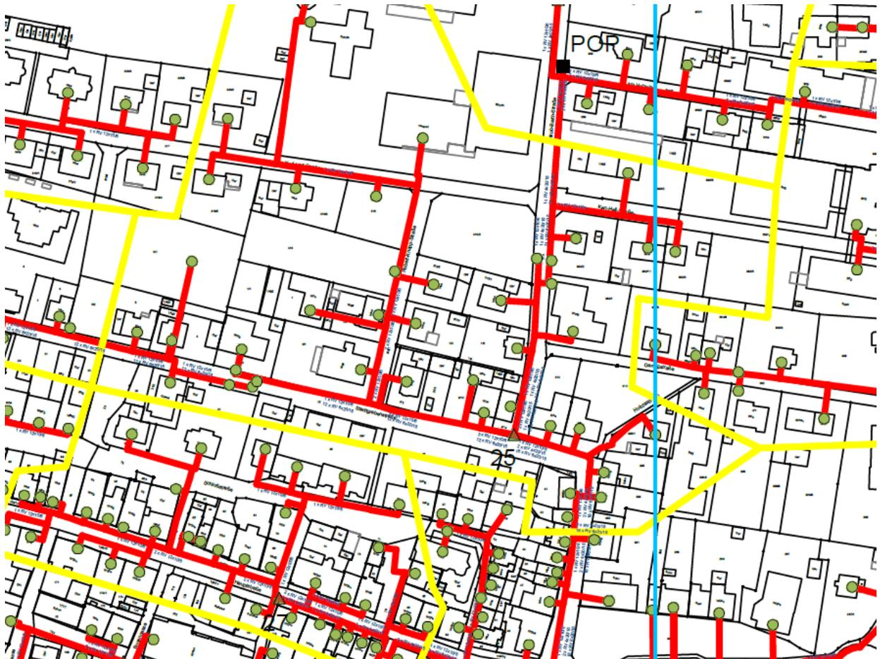
Es handelt sich hierbei um eine Einstrichdarstellung. Die Kenntlichmachung der Rohrverbände erfolgt über eine entsprechende Beschriftung.
